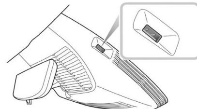
Há uma porta USB na base do espelho retrovisor interno, que pode fornecer 5V de tensão e 2A de corrente máxima como uma tomada elétrica após o veículo ser ligado.
