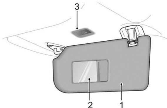
Os para-sóis (1) estão dispostos no teto à frente do condutor e do passageiro dianteiro. Os para-sóis são equipados com espelho de cortesia (2) e iluminação do espelho (3)\*.
