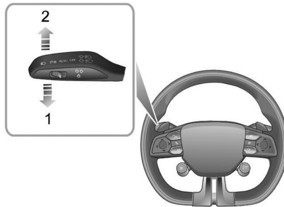
Quando o veículo estiver ligado, mova a alavanca do interruptor de iluminação para cima ou para baixo para acender a lâmpada de sinalização. A lâmpada indicadora VERDE correspondente no painel de instrumentos piscará quando as lâmpadas de sinalização estiverem funcionando.
