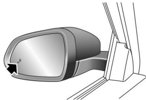
Ao dirigir a uma velocidade de 15 km/h e o sistema detectar um veículo se aproximando no ponto cego do retrovisor, ou um veículo se aproximando da faixa adjacente, a lâmpada de aviso no lado correspondente acenderá. Se a lâmpada do indicador de direção do mesmo lado estiver acesa, a lâmpada de aviso piscará, alertando o condutor que é perigoso continuar mudando de faixa.
