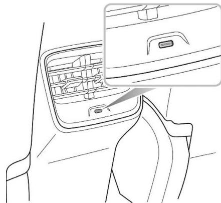
Há uma porta USB no console central traseiro, que pode fornecer 5V de tensão e 3A de corrente máxima como tomada elétrica após o veículo ser ligado.
