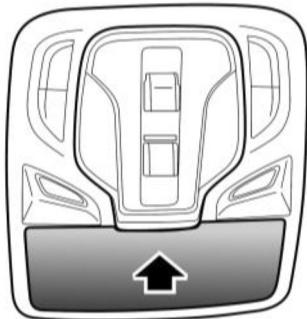
O porta-óculos está localizado próximo à luz interior dianteira. Abra o porta-óculos pressionando o painel inferior (conforme indicado pela seta) e coloque os óculos.
