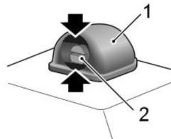
Acione o lavador para pulverizar água periodicamente para verificar se os esguichos de lavagem estão limpos e na direção correta. Se o esguicho estiver obstruído, insira uma agulha ou fio de metal fino no orifício para remover a obstrução.
