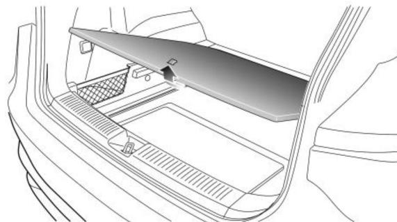
Levante a alça do carpete do porta-malas para ter acesso ao compartimento de armazenamento, que pode ser usado para armazenar ferramentas e outros itens.
