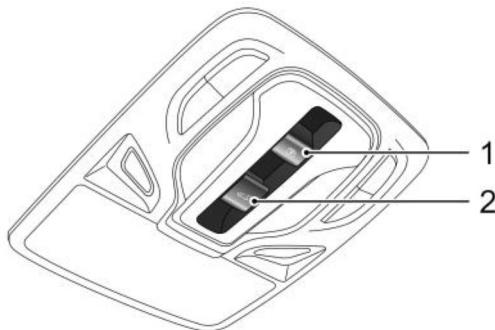
O interruptor do teto solar está localizado no teto acima do para-brisa. Dependendo de diferentes configurações, os estilos do console do teto são diferentes, mas os interruptores do teto solar estão na mesma posição. Os métodos de abertura do teto solar podem ser identificados de acordo com os símbolos do interruptor. O interruptor 1 será usado para operar a cortina do teto solar, e o interruptor 2 será usado para operar o vidro do teto solar.
