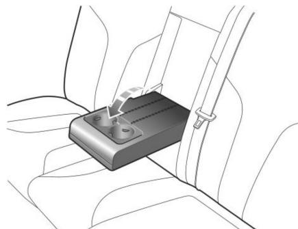
Dobre para frente para abrir o apoio de braço traseiro. A extremidade dianteira do apoio de braço traseiro está equipada com um porta-copos, que pode segurar copos de bebida, etc.
