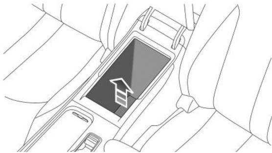
Levante o descanso de braço do console central (conforme indicado pela seta) para abrir o compartimento de armazenamento do console central. Empurre a tampa para baixo para fechar o compartimento de armazenamento.
