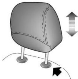
Ao ajustar um encosto de cabeça da posição baixa para a alta, puxe o apoio de cabeça diretamente para cima e pressione suavemente para baixo após atingir a altura desejada, garantindo que ele esteja travado na posição. Para remover o encosto de cabeça, pressione e segure o botão (conforme indicado pela seta) no lado esquerdo do apoio de cabeça, em seguida, puxe o encosto de cabeça para cima para removê-lo.
