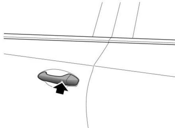
**Nota: Mantenha a distância entre a chave inteligente e a maçaneta da porta dentro do alcance de 1,5 m para travar e destravar as portas usando a função sem chave.**
