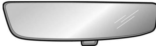
Mova a alavanca na base do espelho retrovisor interno para alterar seu ângulo, a fim de alcançar a função antifuscante. A visibilidade normal é restaurada puxando a alavanca novamente.
