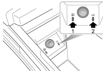
A tomada elétrica do console frontal está localizada dentro da caixa do apoio de braço do console central, que pode fornecer uma tensão de 12V e uma corrente de 10A como uma tomada elétrica quando o veículo estiver ligado.
