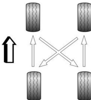
**Nota:** Pneus direcionais (identificados pela seta na lateral do pneu) NÃO podem ser trocados de lado.
