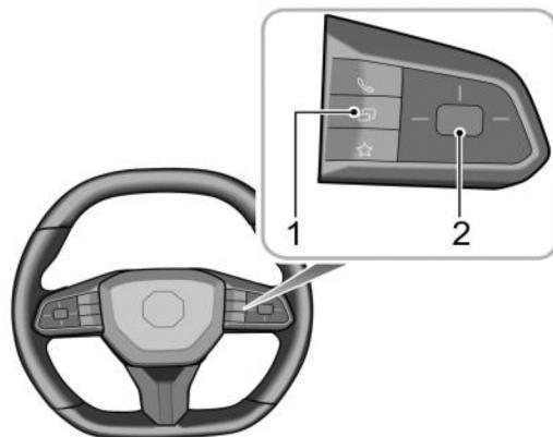
As mensagens do Carrod podem ser interrompidas através do botão ☎ (1) no volante. Pressione longamente o botão de controle quadrado (2) no lado direito do volante para redefinir a mensagem da viagem/eliminar a mensagem de aviso/interromper a mensagem de mau funcionamento.
