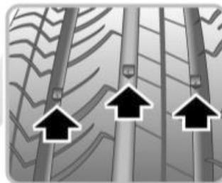
Quando a banda de rodagem estiver desgastada até 1,6 mm ou menos, os indicadores chegarão à superfície de banda de rodagem, produzindo o efeito de uma faixa contínua de borracha em toda a largura do pneu.
