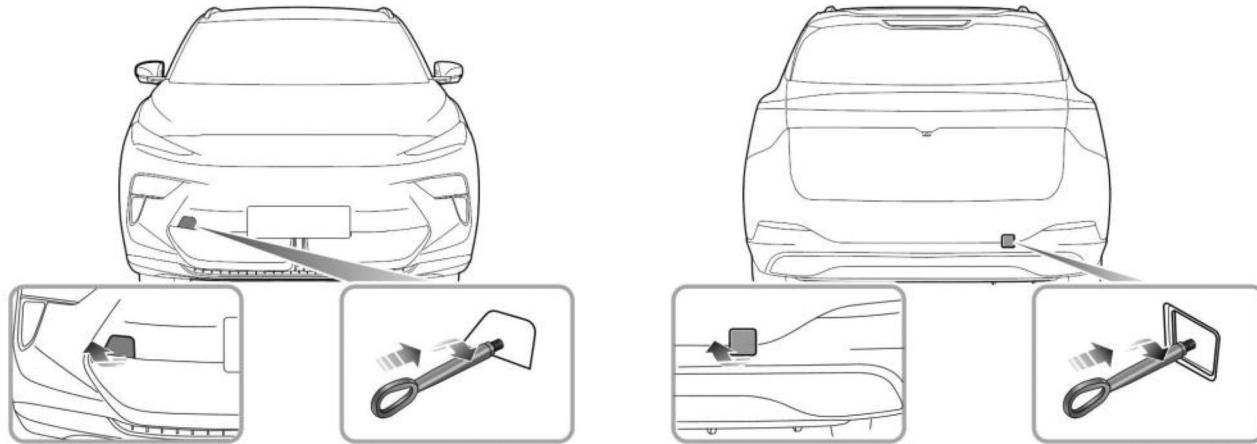
Seu veículo está equipado com 2 olhais de reboque (localizados na frente e na traseira do veículo), que são usados para encaixar o gancho de reboque do kit de ferramentas. O kit de ferramentas está posicionado sob o tapete do porta-malas. Para encaixar o gancho de reboque, remova a pequena tampa do para-choque. Durante a remoção, a pequena tampa frontal pode ser alavancada na parte inferior e aberta na direção mostrada na imagem.
