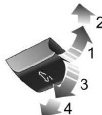
Empurre o interruptor do vidro do teto solar para a posição 1 e segure. O teto solar será aberto manualmente por inclinação. A operação do teto solar pode ser interrompida a qualquer momento soltando o interruptor.
