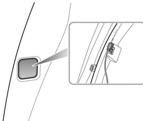
Puxe a alça do cabo de liberação, remova o plugue do conector mantendo a tensão no cabo, isso liberará o dispositivo de travamento.
