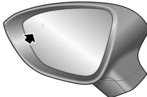
Caso haja risco ao dar ré, a lâmpada de aviso no lado correspondente será iluminada, fazendo com que o painel de instrumento e a tela de entretenimento mostrem uma mensagem de aviso. Se o condutor não tomar medidas de segurança, o sistema realizará uma frenagem de emergência.
