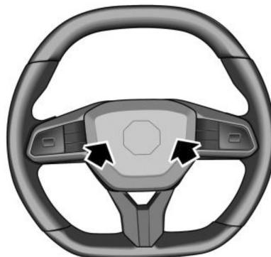
Pressione a área do botão da buzina no volante (conforme indicado pela seta) para operar a buzina.
