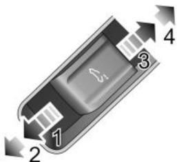
Empurre o Interruptor do vidro do teto solar para trás até a posição (3) e segure, isso permitirá que o teto solar deslize manualmente para abrir. O movimento do teto solar pode ser interrompido a qualquer momento soltando o Interruptor.
