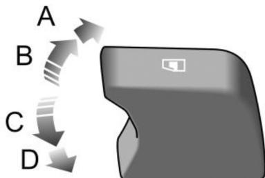
Pressione o interruptor de controle do vidro (1 ~ 4) para baixo até a primeira posição (Posição C) para abaixar o vidro, e puxe o interruptor para cima até a primeira posição (Posição B) para levantar o vidro. O vidro parará de se mover assim que o interruptor for liberado.
